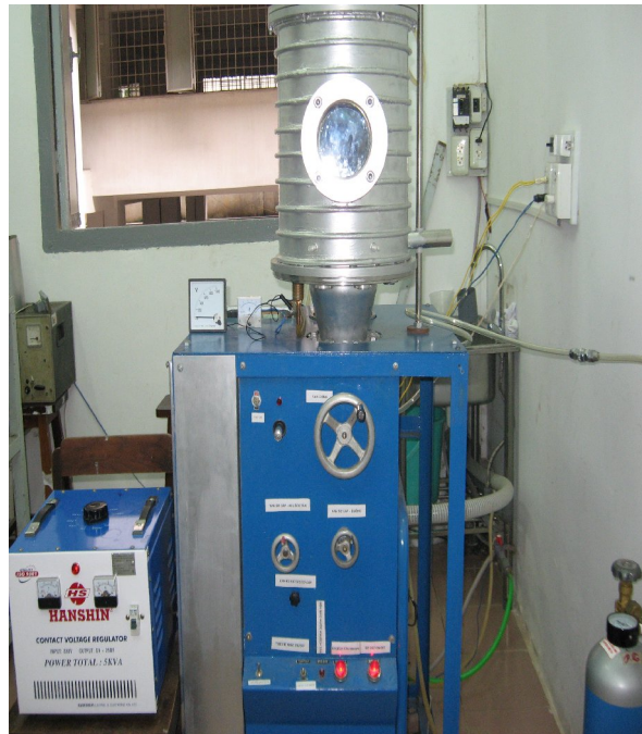
Hình 5. 2: Hệ phún xạ magnetron tại phòng thí nghiệm Quang – Quang phổ, Bộ môn Vật Lý Ứng Dụng, Trường ĐH Khoa Học Tự Nhiên TP.HCM
